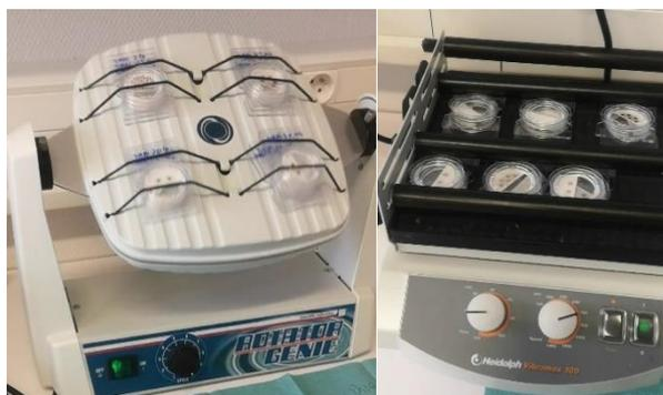
Figure 19 : Photographies des appareillages utilisés pour les tests de stabilité : Rotator (à gauche) et Vibramax (à droite)
