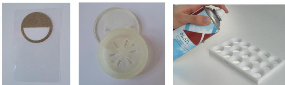
Figure 16 : Exemples de masques de graissage pour, de gauche à droite, les supports MMI, MA et S (photo DEKATI®)
