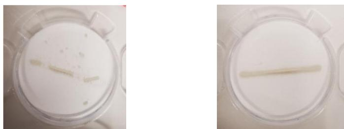
Figure 3 : Photographies des supports de l'étage supérieur (D<sub>50</sub> le plus important) pour des prélèvements par impacteur Sioutas avec supports non graissés (à gauche) et graissés (à droite)
