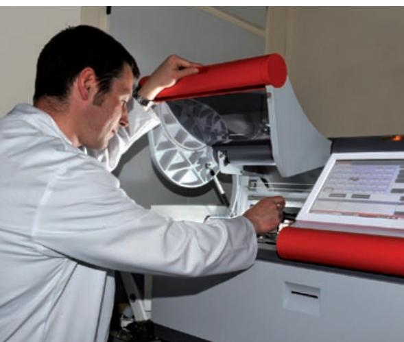
Analyse par spectrométrie de fluorescence x des métaux
