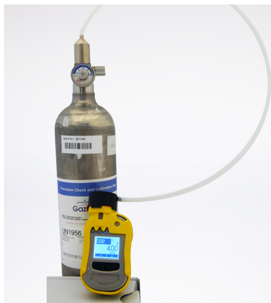
← FIGURE 2 Vérification de la réponse d'un détecteur professionnel à l'aide d'une bouteille étalon contenant 1 000 ppm v de CO 2 . Le même dispositif permet si nécessaire de réaliser un calibrage. La coiffe ou masque de vérification est la pièce noire qui vient recouvrir complètement l'entrée de gaz du détecteur.
