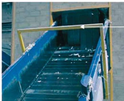
Portique supportant la boucle ceinturant le convoyeur
