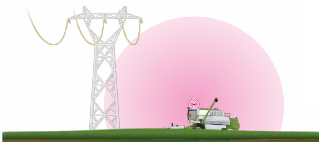
Figure 15. **Représentation schématique d'une ensileuse automotrice et du volume de détection théorique minimal paramétré pour un DLEAST à capteur unique installé sur le toit de la cabine du véhicule**
