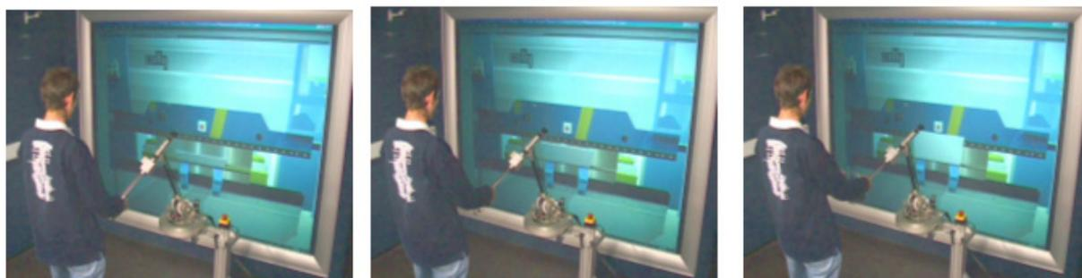
*Figure V.114 : Simulation dynamique d'un pliage de tôle avec le bras à retour d'effort*
