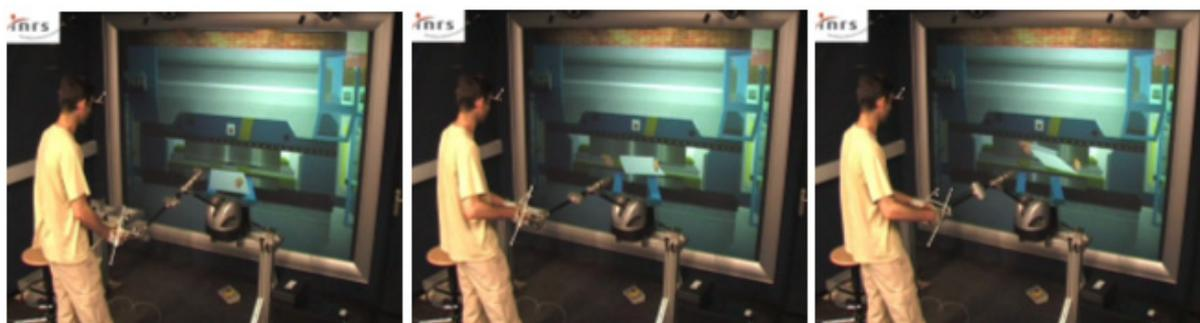
*Figure V.130 : Pliage de tôle simulé avec les mains virtuelles et le retour d'effort*
