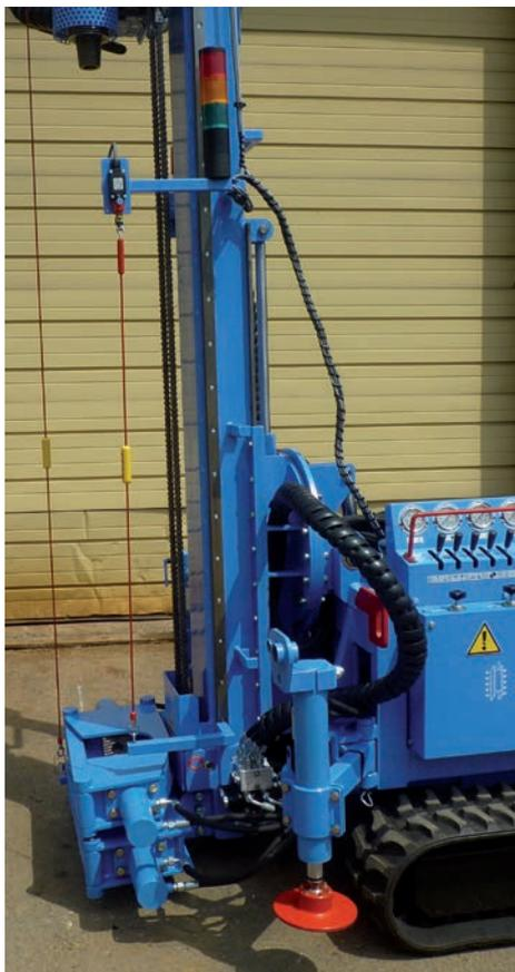
Figure 47. Illustration de la mise en œuvre d'un câble sensible sur une foreuse
