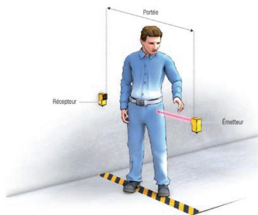
Figure 20. Dispositif à faisceau lumineux unique
