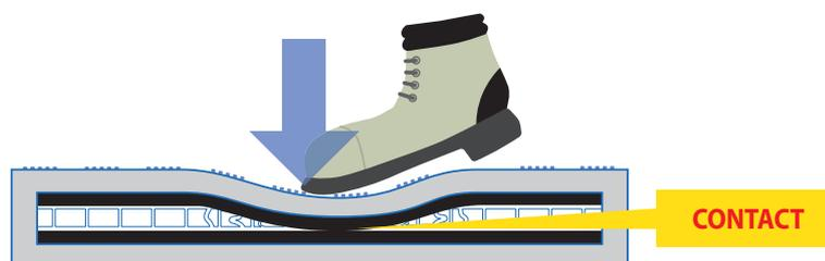
Figure 37. Principe de fonctionnement d'un tapis sensible
