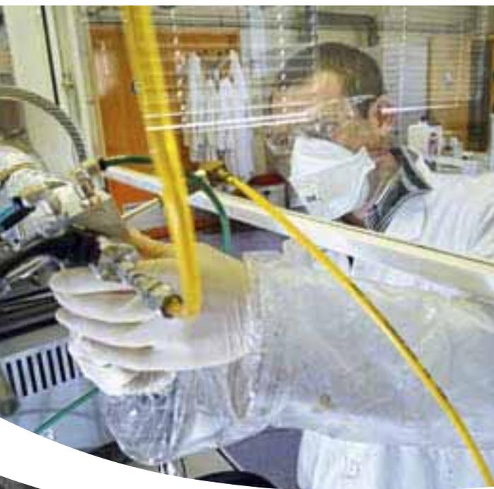
Préparation d'un réacteur de croissance de nanotubes de carbone
