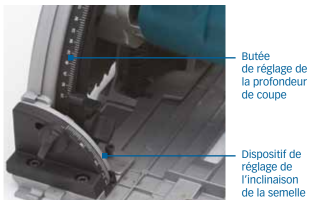
Figure 8. Exemple de butée de profondeur et de dispositif d'inclinaison sur une scie portable à coupe plongeante.
