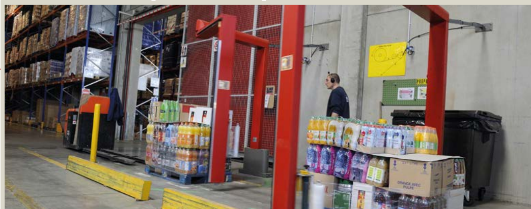
Figure 12. Poste de filmage automatique
