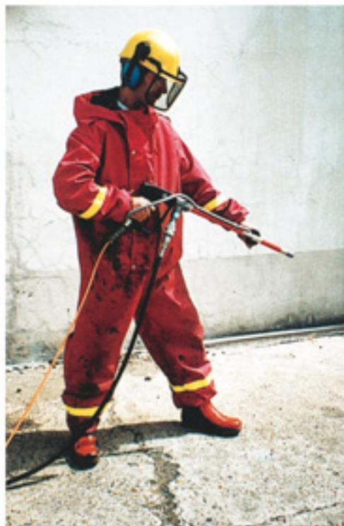
*La commande bimanuelle est la solution idéale pour les travaux au pistolet court.*
