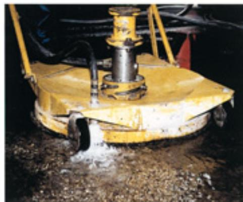
*Accessoires de projection conçus pour dériver le flux de liquide dans un conduit de décharge en l'absence d'action sur le dispositif de commande.*
