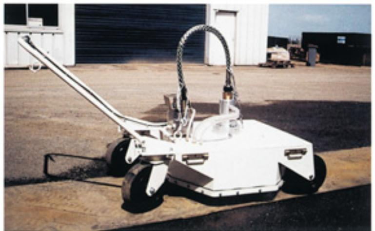
*Avec de telles tresses, on évite que le tuyau s'écarte sans contrôle quand le raccord est endommagé.*
