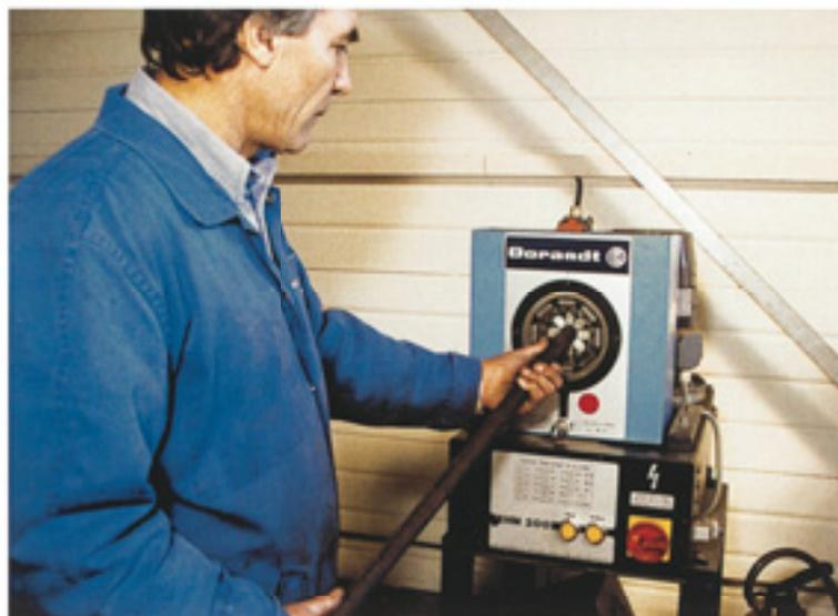
*Le sertissage des embouts ne doit être confié qu'à des techniciens compétents, disposant de tout l'outillage spécifique nécessaire à cette opération.*
