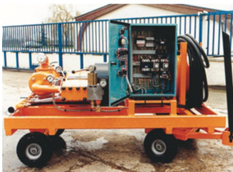
*Groupe à haute pression : le circuit d'alimentation, la pompe, les équipements de contrôle et de régulation, l'armoire de commande.*
