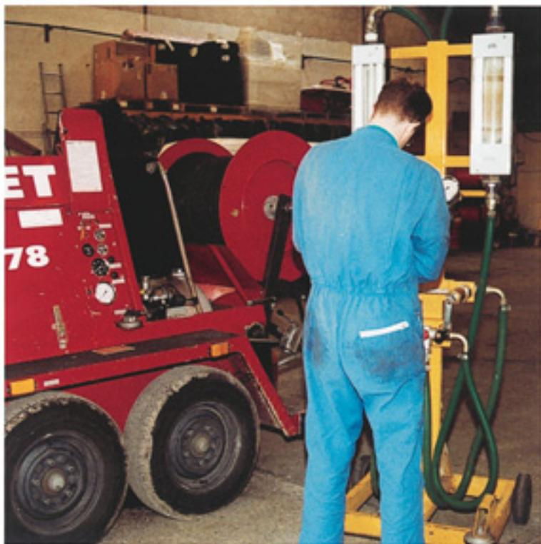
*Les opérations de contrôle du manomètre, de la soupape de sécurité... doivent être effectuées régulièrement au moyen d'équipements appropriés.*
