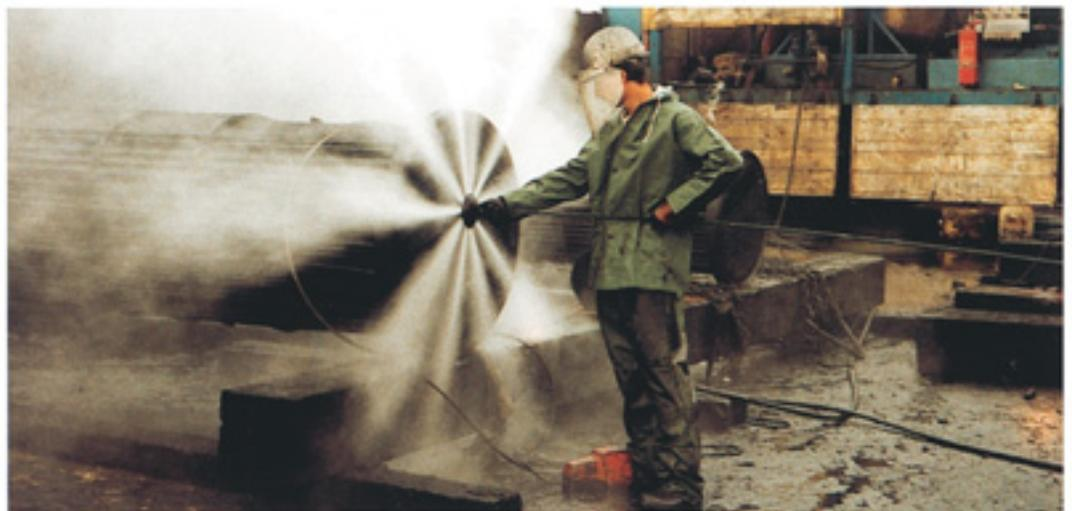
*Une garde coulissante se bloquant sur la buse de projection et munie d'un déflecteur réduit considérablement les risques d'accidents aux mains et protège l'opérateur contre les projections.*
