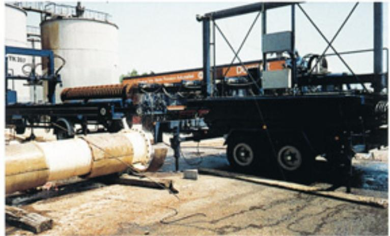
*Eloignement du personnel de la zone dangereuse : la mise en œuvre d'équipements mécanisés contrôlés à distance permet de soustraire l'opérateur au risque présenté par le jet issu de la buse.*
