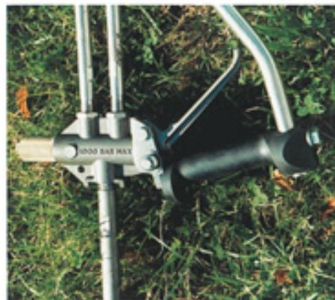
*L'indication en clair de la pression maximale admissible est le seul moyen fiable pour s'assurer que chaque composant est bien adapté à la pression maximale d'utilisation.*
