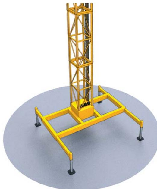
Fig. 23. Châssis muni de quatre appuis au sol, montés sur quatre bras extensibles liés à la base
