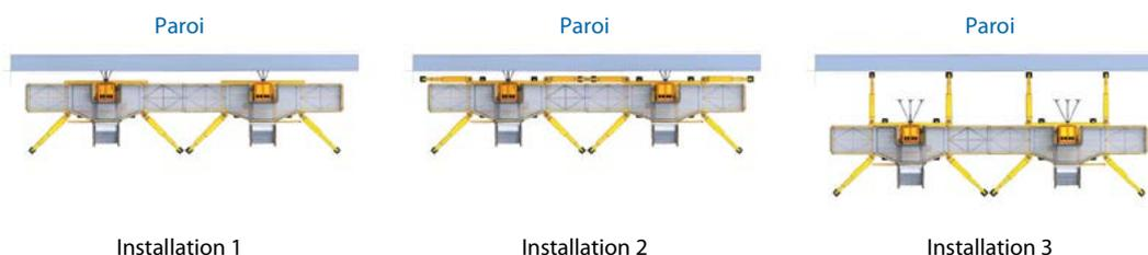
Fig. 24. Différentes installations du châssis de base
