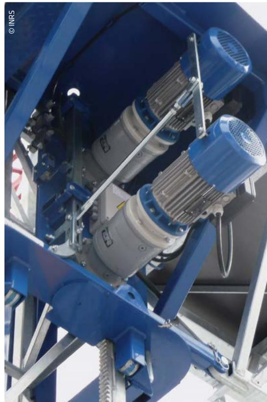
Fig. 52. Commande simultanée de déblocage manuel du frein des deux moteurs de levage accessible depuis la plate-forme
