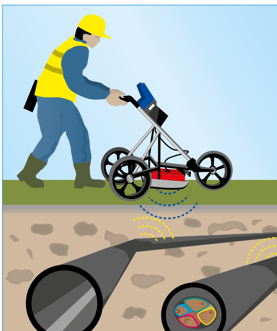
Figure 17. Radar à pénétration de sol (RPS)
