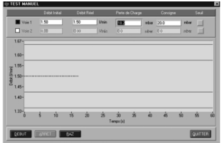
Fig. 4. Suivi du débit en temps réel en fonction de la perte de charge appliquée (limites horizontales : \pm 5\% et \pm 10\% du débit initial) - Real-time flow rate monitoring in relation to pressure drop applied (horizontal limits: \pm 5\% and \pm 10\% of initial flow rate)
