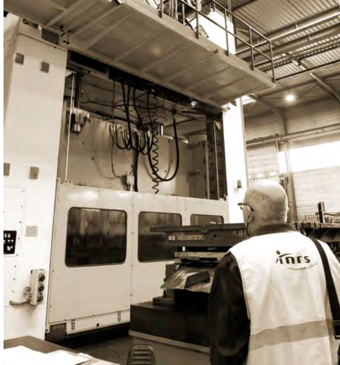
L'INRS a conduit une étude sur de nouvelles presses à servomoteur afin d'analyser leur impact sur les fonctions de sécurité et les moyens de protection habituellement mis en œuvre pour les presses.
