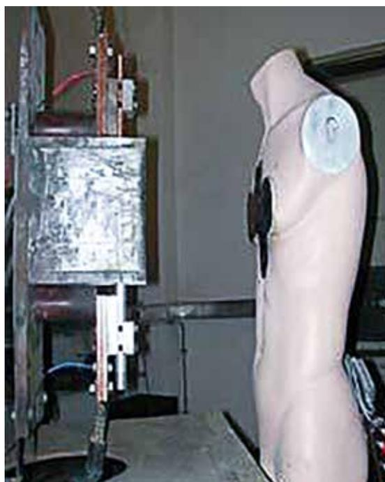
← FIGURE 8 Dispositif de test pour la méthode dite « à la boîte ».
