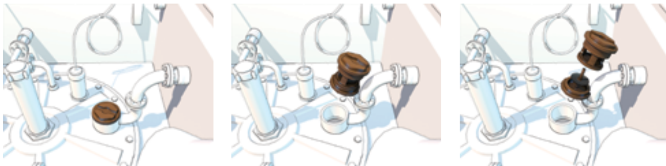
Figure 10. Tête de clapet, de l'état monté à démonté
