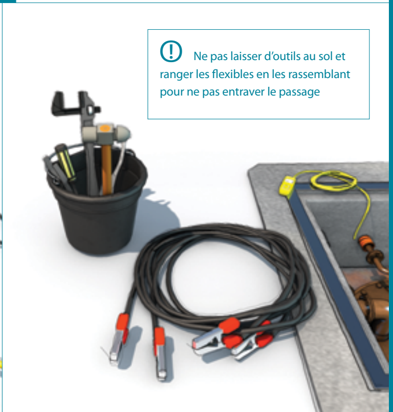
Figure 12. Des outils bien rangés pendant toute l'intervention
