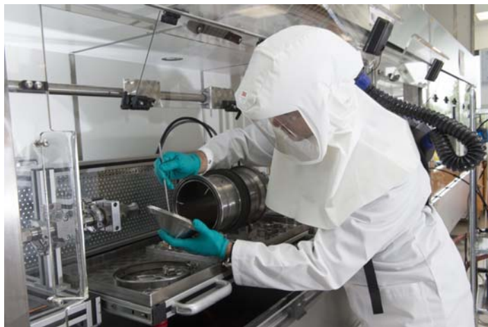
Nettoyage d'un banc d'essais sous une enceinte ventilée dans le Pôle nano. Crédit : Serge Morillon/INRS
