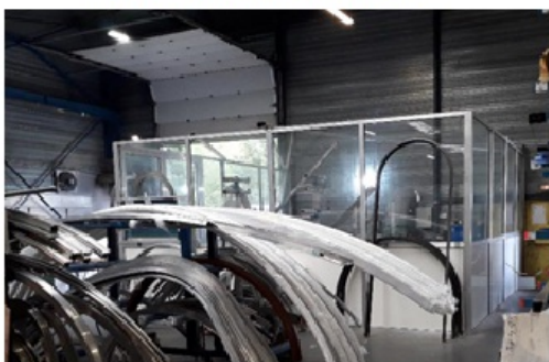
Avant : ponçage dans une zone délimitée par des cloisons
