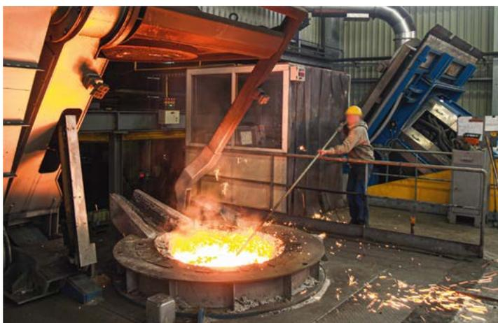
Figure 2. Four à induction utilisé en fonderie pour réaliser les alliages ferreux (acier, fonte)
