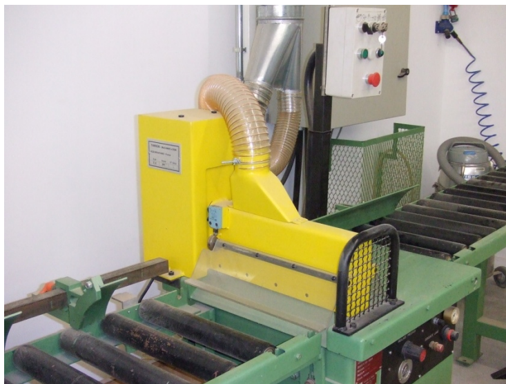
Protecteur Theta pour tronçonneuse à lame escamotable (issu d'une étude INRS) Marque déposée n° 073545649
