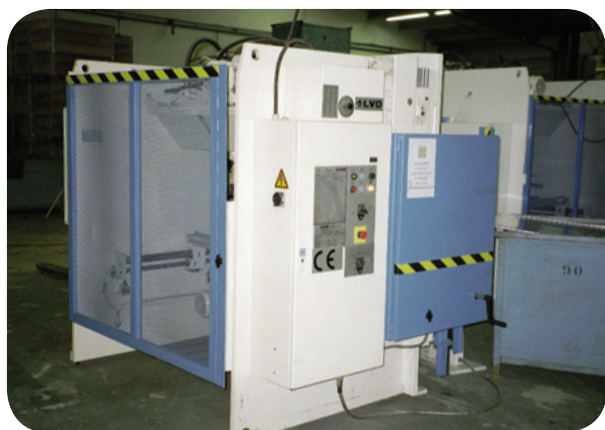
Figure 16 : Exemple de protection de la face arrière.
