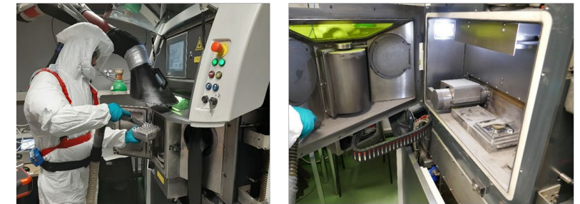
Aspiration au niveau de la bouche mise en place au niveau de la porte de la machine de l'ordre de 1300 m 3 /h
