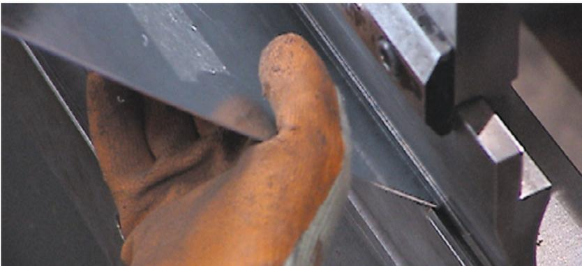
Le port de gants adaptés aux tôles manipulées est une contribution à la sécurité des opérateurs
