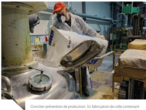
Concilier prévention de production. Ici fabrication de colle contenant des nanoparticules de silice amorphe, l'atelier est équipé d'un système d'aspiration et l'opérateur protégé par un masque équipé de filtres anti-aérosols, une blouse jetable, des lunettes, gants et manchettes.
