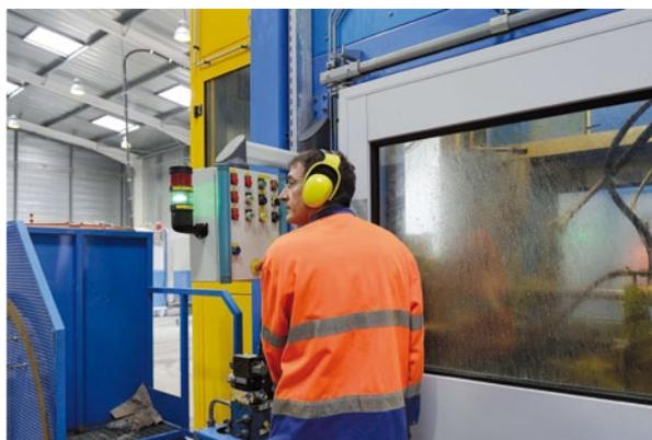
Encoffrement de machines mis en place à la suite d'études de l'INRS, de la CARSAT Normandie et du Centre Interrégional de contrôles physiques de la CARSAT Centre. Le bruit dans l'atelier a été réduit de 105 dB à 80 dB.
