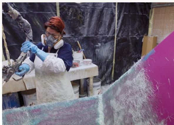
Plusieurs outils de l'INRS aident au choix d'EPI adaptés aux situations professionnelles. Ici fabrication de pièces composites nécessitant le port d'un masque filtrant.
