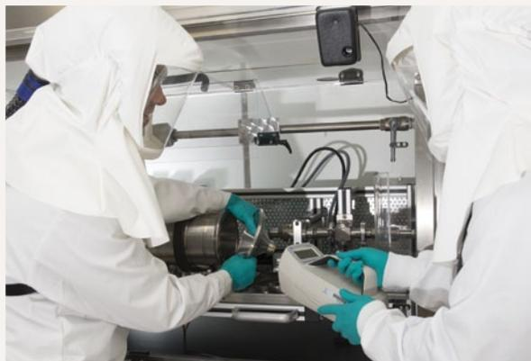
Banc d'essais INRS Nanodrum pour l'étude de la pulvérencence des nanomatériaux sous forme de poudre.
