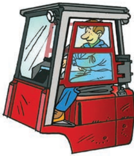
↑ Portière de cabine ajourée, c'est-à-dire qui ne colle pas au pourtour de la cabine du chariot
