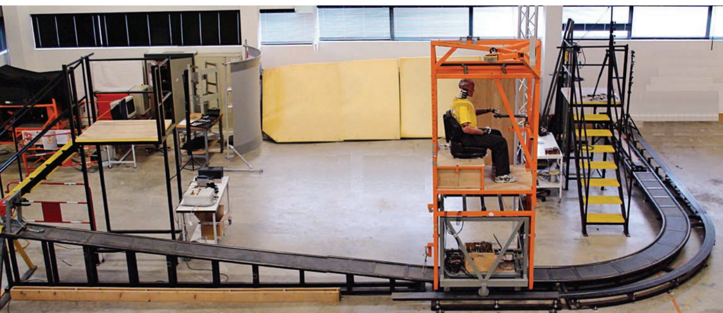
↓ FIGURE 1 Banc de renversement avec le mannequin installé au poste de conduite.
