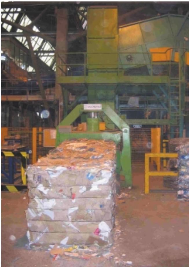
Fig. 1. Presse à balles et convoyeur dans un centre de tri de déchets recyclables.
