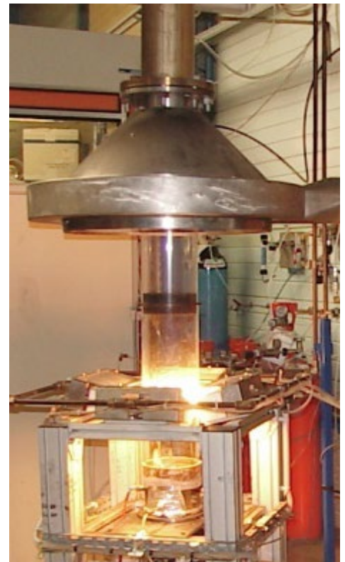
Calorimètre de Twarson (FPA) couplé à un spectromètre FTIR
