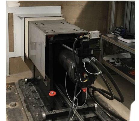
Presse 500 kN pour essai d'écrasement
