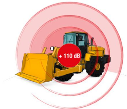
La puissance acoustique représente l'énergie sonore rayonnée par la machine dans toutes les directions. Le niveau de puissance acoustique s'exprime aussi en décibels pondérés A. C'est aussi une grandeur caractéristique de l'émission sonore de la machine.
