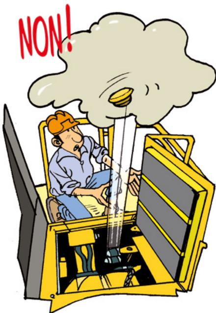
Laissez refroidir l'huile hydraulique avant de purger ou de vidanger les circuits.
