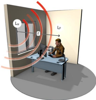
par la machine vers le poste de travail dans des conditions d'utilisation bien définies et normalisées (50% de la charge nominale, mesurage vitre fermée, etc.) et dans un environnement acoustiquement neutre (dépourvu de réflexions par des parois et sans aucune autre source de bruit en fonctionnement). Ce niveau n'est pas le niveau d'exposition sonore du conducteur de la machine, qui dépend de la durée d'exposition et des conditions réelles d'utilisation de la machine.
