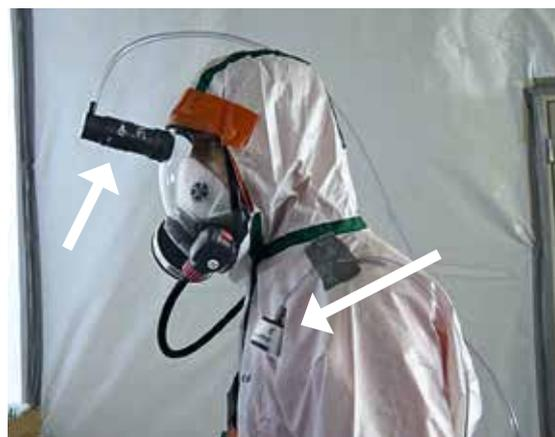
← FIGURE 1B : Équipement d'un opérateur: cassettes de prélèvement.
