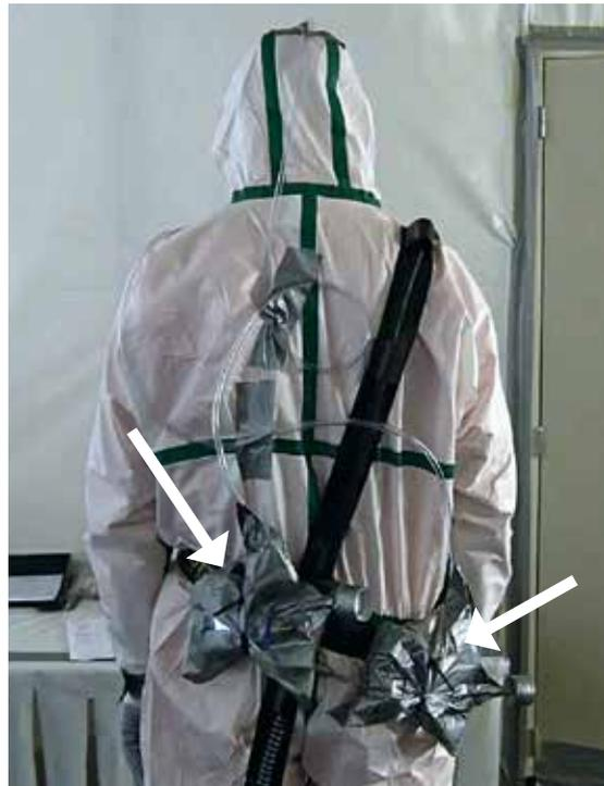
← FIGURE 1A : Équipement d'un opérateur: pompes de prélèvement.
