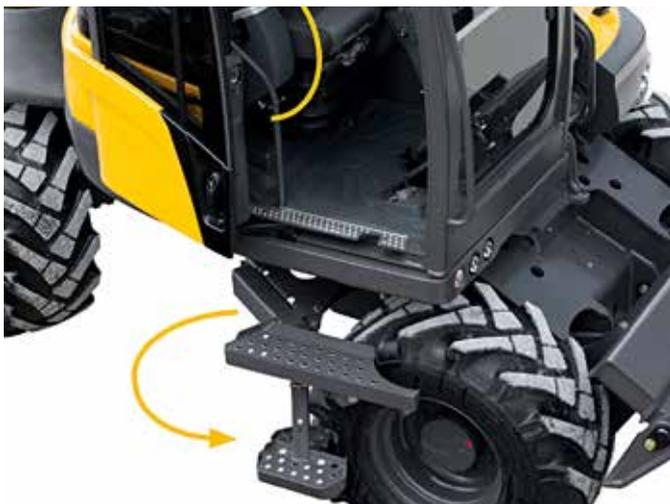
↑ FIGURE 1 Le marchepied déployable permet un accès au poste de conduite intuitif, centré, visible et sans surplomb.
