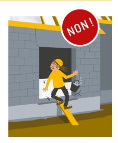
► Remblayer et stabiliser les abords des façades permet la bonne mise en place des dispositifs de sécurité et facilite les approvisionnements tout en diminuant les risques de chute de plain-pied.
