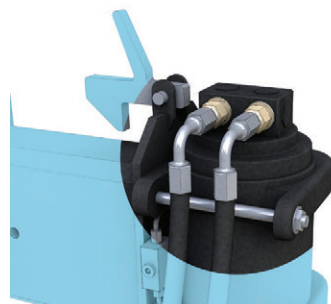
Dispositif hydraulique de maintien de charge sur un vérin de stabilisation
