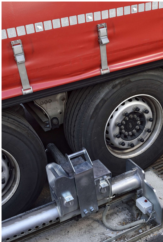
■ Dispositif de calage de roue évitant le départ intempestif du véhicule.
