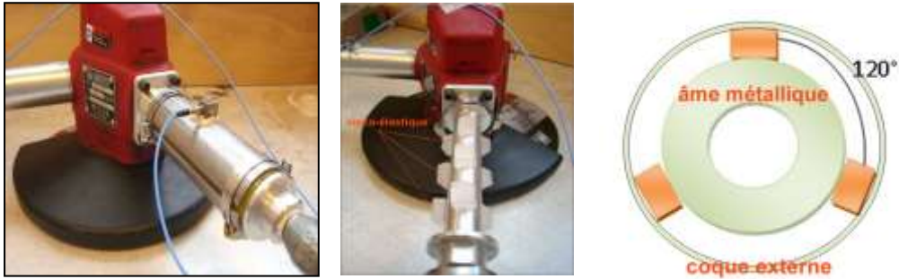
Figure 1.9 Poignée anti-vibratile de meuleuse pneumatique équipée d'un accéléromètre pour mesurer l'émission vibratoire
