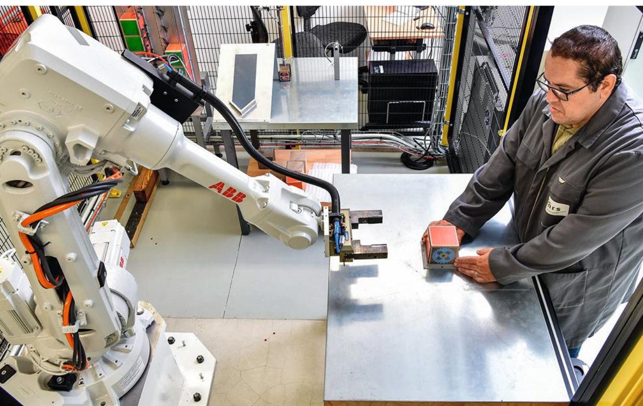
Poste de contrôle qualité sur une cellule collaborative au sein du département Ingénierie des équipements de travail (INRS).
