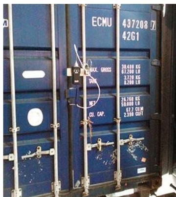
↑ FIGURE 4 Investigation avec un PID actif de la teneur en COV dans un conteneur ciblé en attente d'ouverture.
