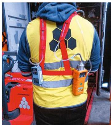
↑ FIGURE 2 Équipement d'un opérateur avec un PID actif placé dans le dos.
