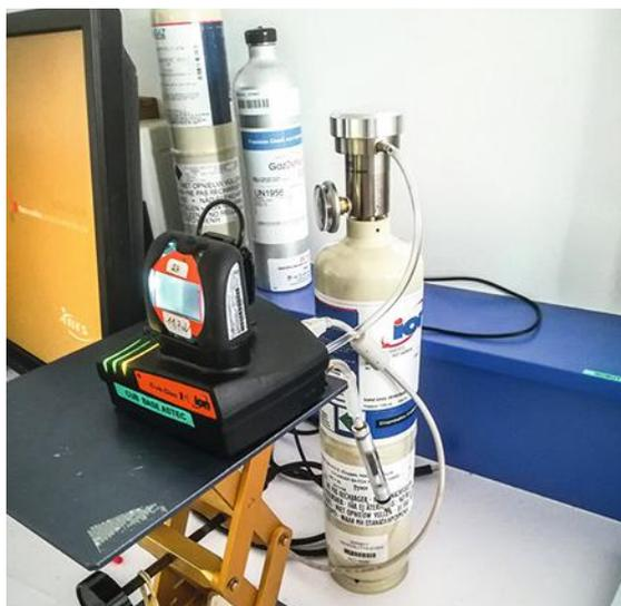
FIGURE 5 → Station automatique et bouteille étalon utilisées pour vérifier, avant chaque essai, la réponse du détecteur PID.
