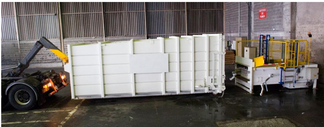
■ Figure 7. Chargement d'une benne désolidarisée de son compacteur
