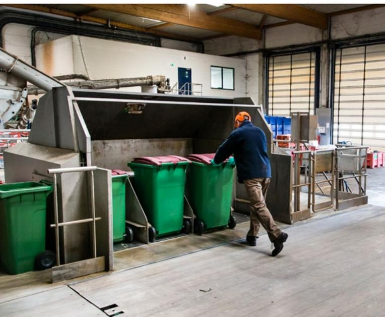
Figure 10. Basculement des bacs sur roues au-dessus de la fosse
