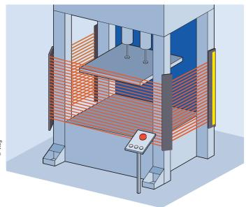
Simple ou multiple, l'emploi des barrières immatérielles peut couvrir de nombreuses situations. À gauche, seul l'accès frontal est contrôlé par une barrière immatérielle. À droite, les trois côtés de la machine restent accessibles.
