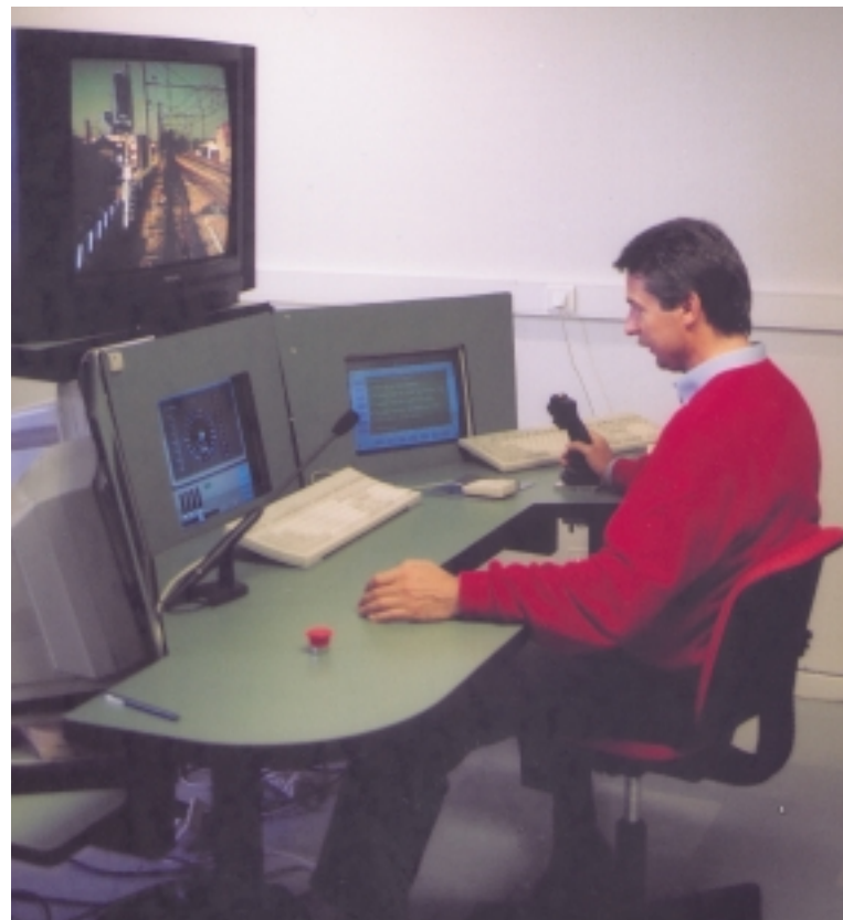
Fig. 3. Plate-forme d'évaluation en vue d'étudier et de valider les différents pré-concepts d'IHM retenus (d'après [20])
