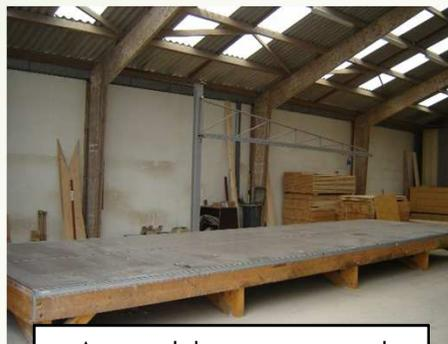
Assemblage manuel des ossatures sur une table
