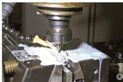
Il existe différentes catégories de FDC comme le montre le *Tableau 1*. Leurs formulations comportent de nombreux additifs ayant notamment comme objectif d'augmenter les propriétés lubrifiantes, de faciliter la coupe, de limiter l'usure de l'outil, la corrosion, la formation de brouillard et le développement des micro-organismes pouvant coloniser les fluides aqueux [1].
