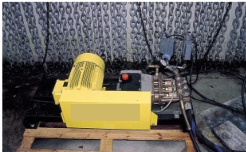
**Fig. 3. Vue de la machine de nettoyage alimentée par un fût de solvant**
