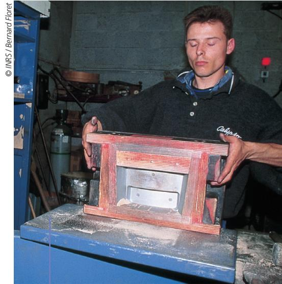
Table pivotante réglable en hauteur pour le transfert de boîtes à noyaux
