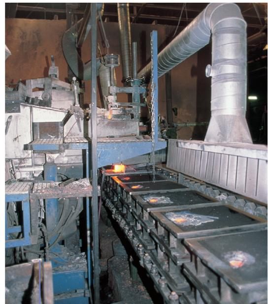
Moules en sable en cours de refroidissement avec rampe de captage des fumées
