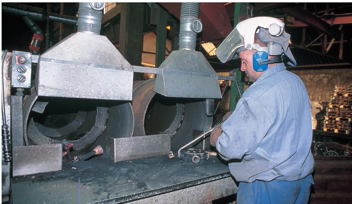
Tonneaux de décochage équipés d'un système de captage des poussières
