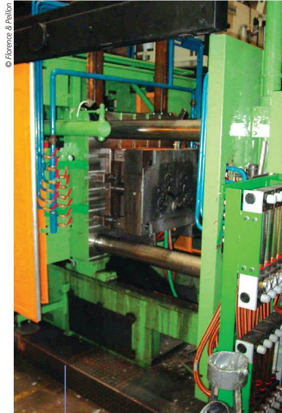
*Machine de moulage sous pression*
