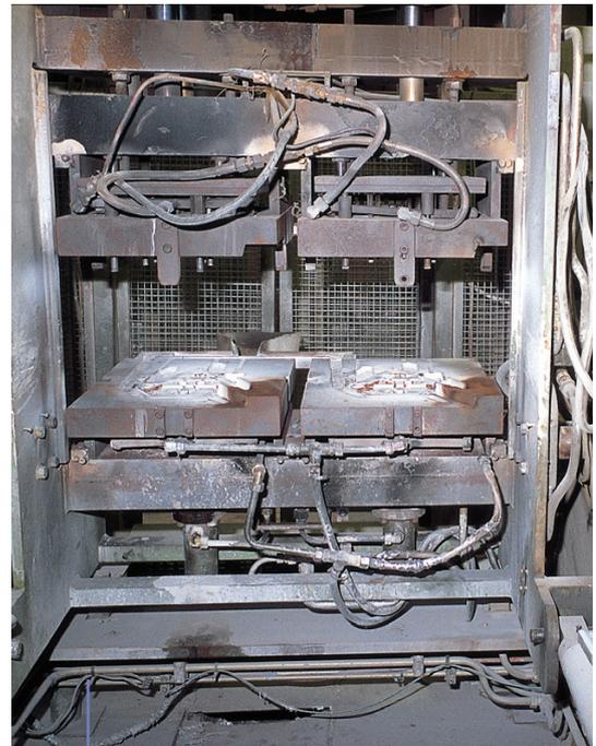
Coquilleuse automatisée, le moule est ouvert, en arrière plan les volets mobiles permettant l'accès du robot de coulée
