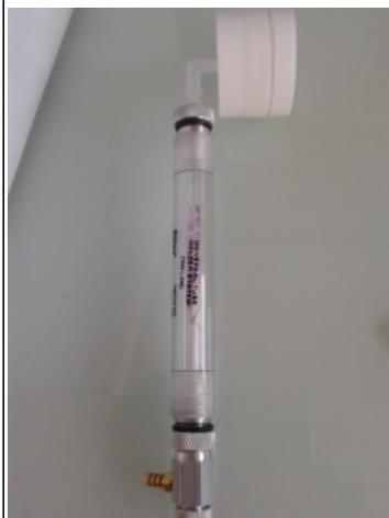
Le tube est placé dans un porte tube et raccordé à la cassette à l'aide de connexions de type luer en polypropylène afin d'assurer l'étanchéité entre cassette et tube. La perte de charge de l'ensemble est d'environ 9,22 kPa (37 pouces d'eau) à 1 L/min
