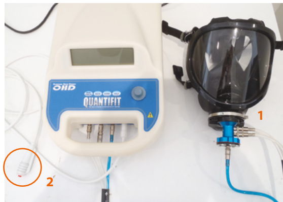
Figure 1. Description du montage pour la réalisation de l'essai d'ajustement au Quantifit
