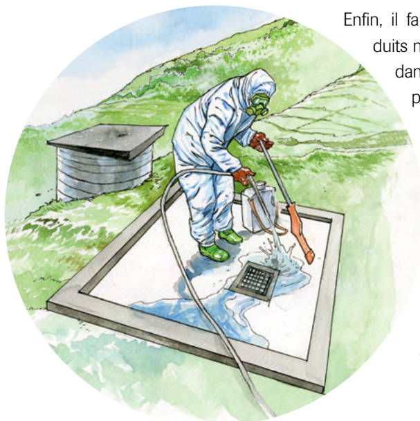
Aire de lavage du matériel avec récupération des eaux de lavage (bassin de récupération en contrebas).
