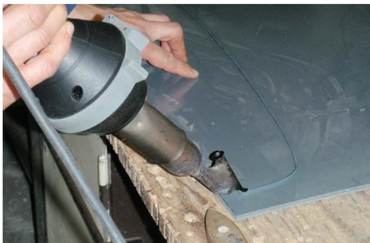
Opérateur réalisant une soudure manuelle de matières plastiques.
