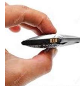
Batterie de téléphone gonflée
