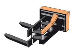
Tête pivotante bi ou tridirectionnelle à droite ou à gauche, elle permet la prise des palettes selon trois axes différents. Cet équipement est surtout utilisé dans les entrepôts possédant des allées étroites.
