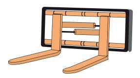
On l'utilise généralement pour des manutentions exigeant une haute précision, par exemple le chargement de conteneurs, de poids lourds ou wagons de chemins de fer. Pour les entreprises manutentionnant deux palettes à la fois avec quatre bras de fourche, il existe des appareils à double position.
