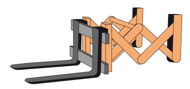
Dispositif à ciseaux permettant de réaliser une manutention à une distance supérieure au gabarit du chariot. Cet appareil est utilisé pour le déchargement latéral des poids lourds, mais on peut également l'utiliser pour empiler des palettes en profondeur.
