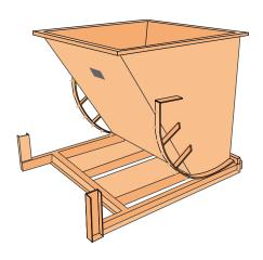
Équipement, constitué par un godet basculant ou à fond ouvrable, pour collecter des déchets.
