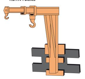
Équipement fixé à l'arrière du porte-fourche ou sur le bras de fourche. Il est composé d'un bras fixe muni d'un crochet coulissant. Attention, le balancement de la charge peut mettre en cause la stabilité du chariot, les potences ne peuvent être utilisées que dans des cas très spécifiques et nécessitent une surveillance particulière.
