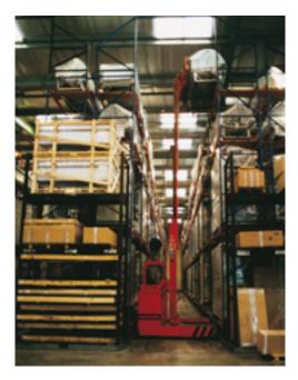
En hauteur : les points bas de la construction et de ses équipements (passage de porte, gaine de ventilation, éclairage, conduites diverses, etc.) déterminent la hauteur hors tout du chariot et de son ensemble élévateur.
