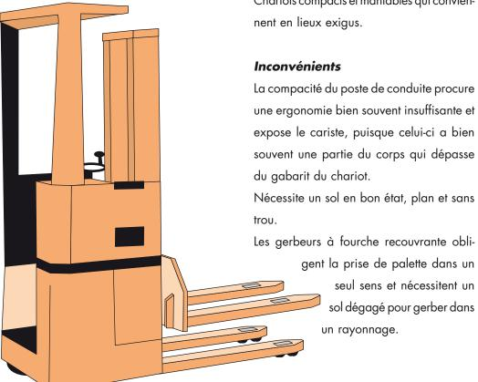
Vitesse d'élévation : varie de 0,25 m/s à vide à 0,20 m/s en charge.
