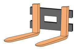
équipement et dont l'écartement peut être réalisé de façon manuelle ou hydraulique. La fourche est généralement constituée de deux bras, mais on peut en admettre trois ou quatre, si le porte-équipement le permet. Il existe plusieurs méthodes de fixation : boulonnée, à œillets ou à tenons\*, ce dernier modèle étant le plus utilisé.
